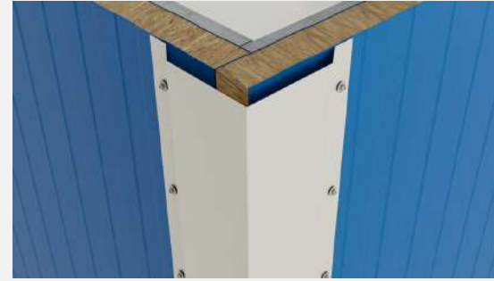
Cephe Paneli Dış Köşe Bir. Detayı Wall Panel Outer Corner Con. Detail
