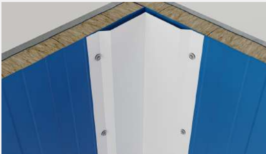
Cephe Paneli İç Köşe Bir. Detayı Wall Panel Interior Corner Con. Detail
