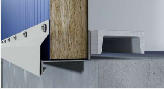
Cephe Paneli Damlalık Detayı Wall Panel Dropper Detail
